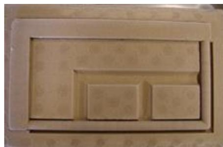
図2-8 主型に組み込んだ凍結中子
