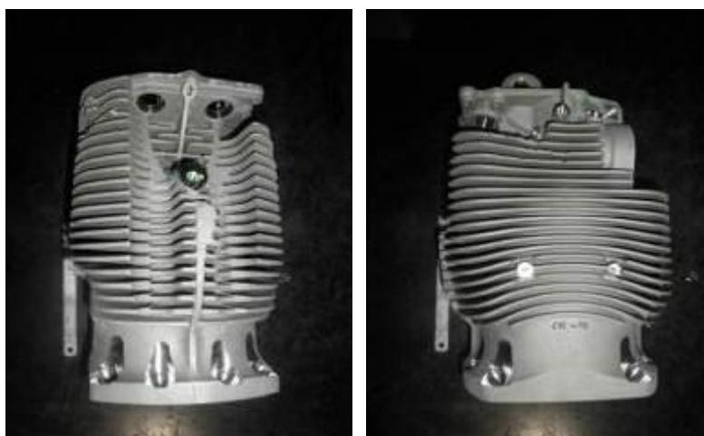
図4-3 試作した製品鋳物
