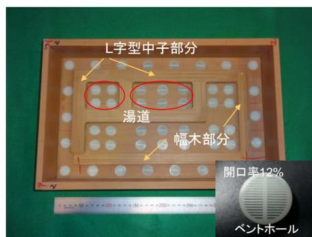
図2-7 凍結主型用型枠
