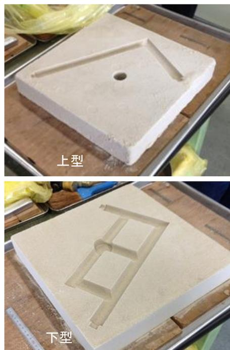
図 2-5 L 字型鑄物用凍結鑄型
