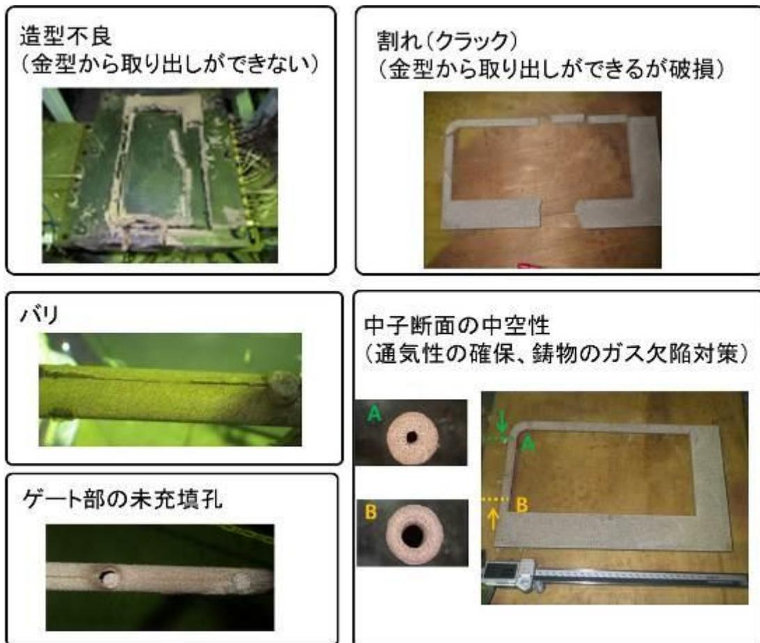
図2-2 成形した中子の不良状態や中空形状での分類
