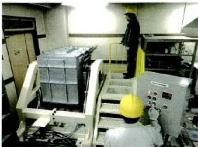
図5-1 高活性・難鋳造材鋳造装置の外観
