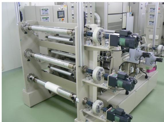
図10：導入したR-t o-Rラミネートロール試験機
