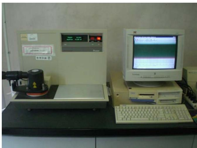
図7：DSC(示差走査熱量計)
