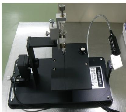
図 11：接触角試験機
