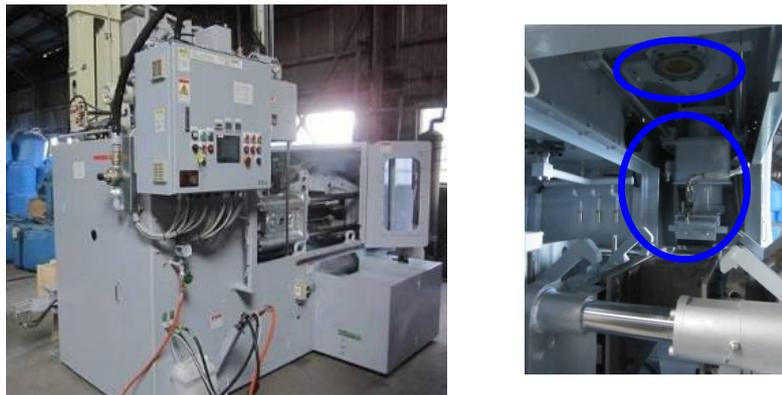
図 1. 押湯スリーブ成型機と高充填吹き込み機構部（○部分）
