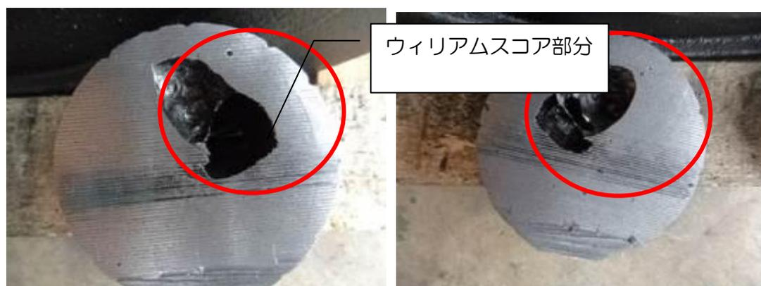
図 17 断熱押湯スリーブ押湯部の引け状態断面写真
