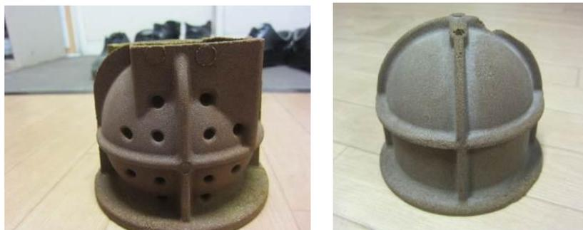
図 3.断熱押湯スリーブの成型例
