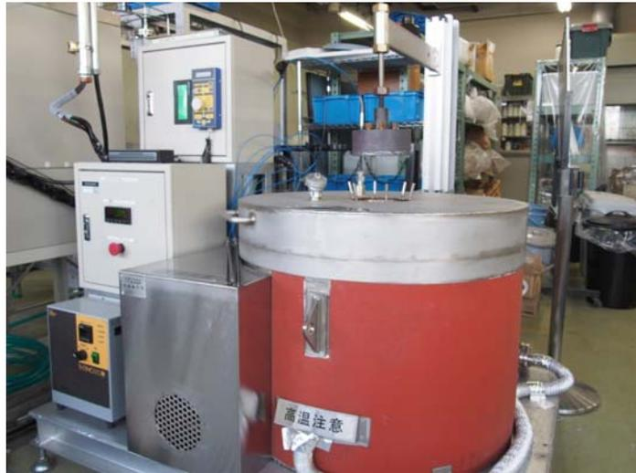
図12 砂型鑄造評価システム
