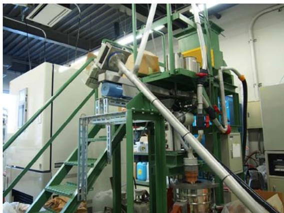
図8 機械的砂再生装置
