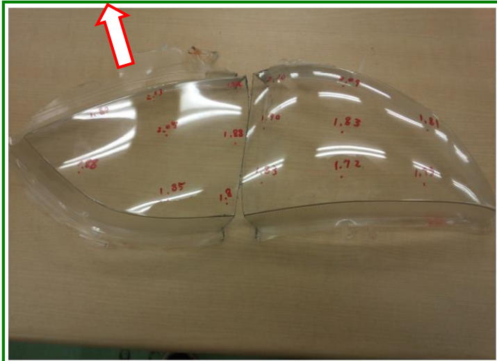
図 4-5-9 肉厚測定結果及び樹脂が流れ出す部分
