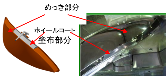
図 4-5-6 可動アルミ入れ子修正
