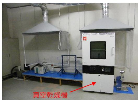
図5-2 改質剤合成装置 (乾燥粉碎機)
