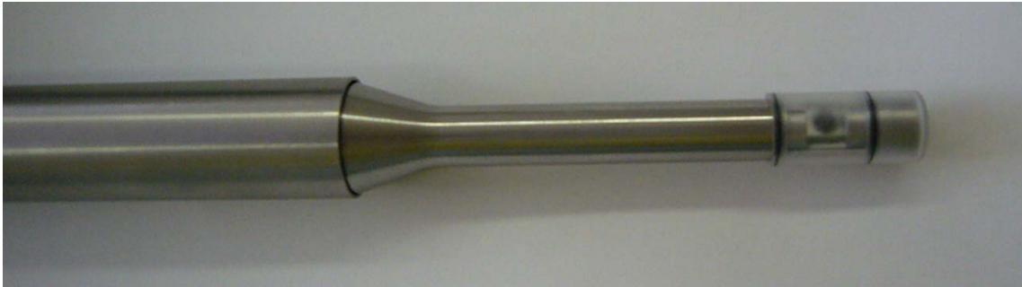
図 17 試作した斜視型スキャニング機構全体写真
