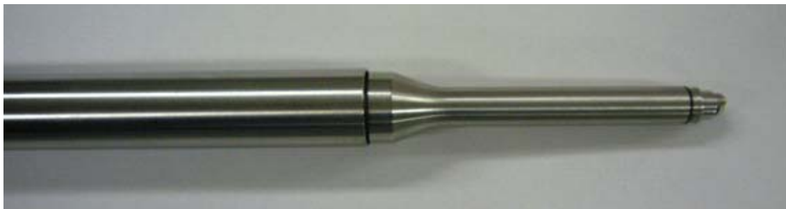
図16 試作した直視型スキャン機構全体写真
