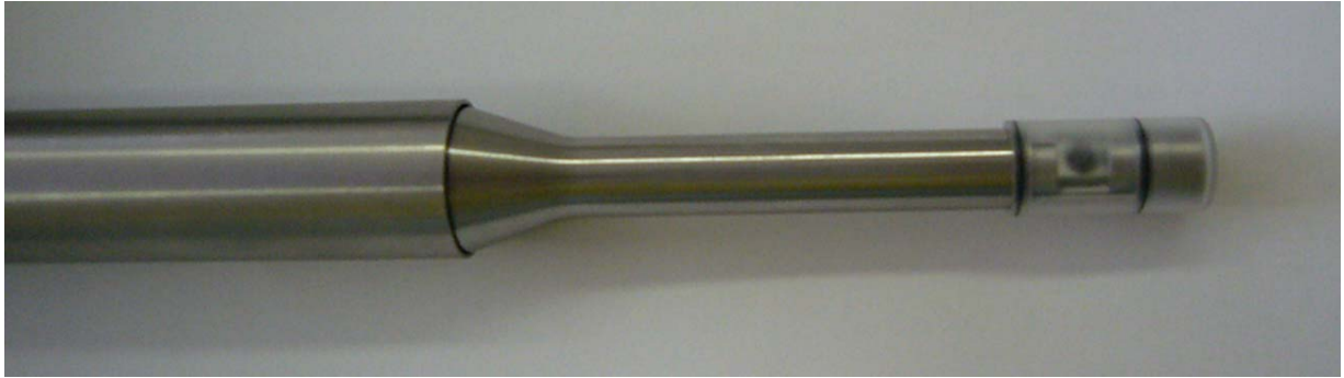
図 11-3 試作した斜視型スキャン機構全体写真
