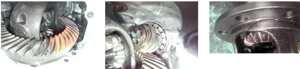
図 2-4.4 デファレンシャルアッシー破損箇所
