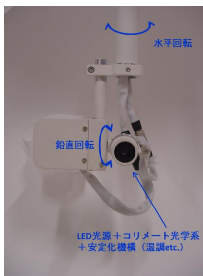
図 4 4 縦型積分球評価装置の光源部および駆動軸
