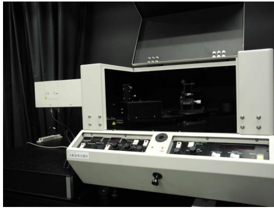
図3 反射配光測定装置の外観（左）および測定原理（右）
