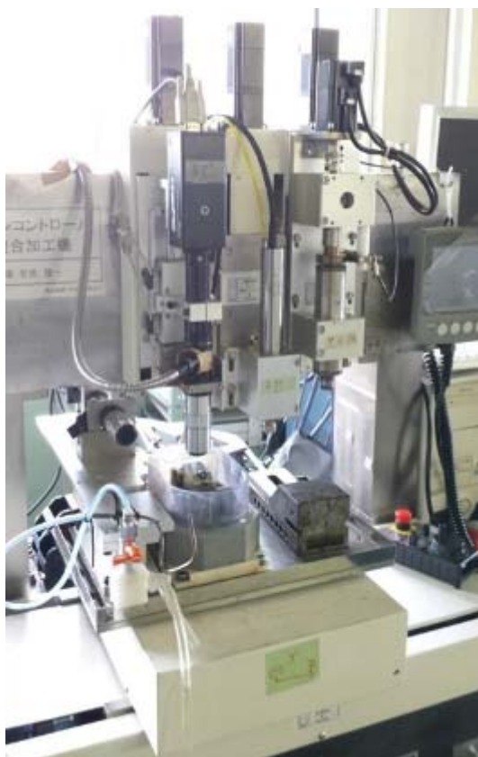
写真 2-3-1 面取り加工に使用した精密 NC 加工機
