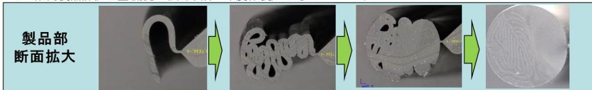
図 21. ショートショットによる材料の金型内流動の確認
