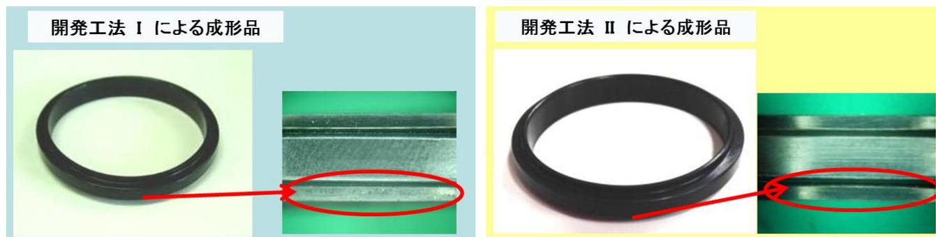
図 24. 開発工法 I(左)、開発工法 II(右)による Tリング成形品
