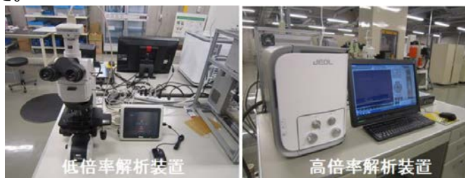
図 2.3.7 開発したマイクロテクスチュア構造解析装置
