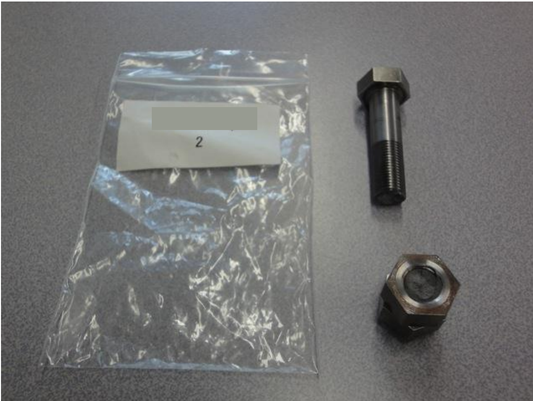
テストピースの破断状況
