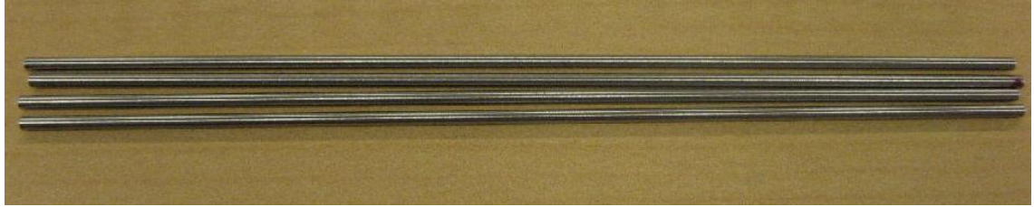
図2-3 ロール成形法で作製したSUS316線材。
