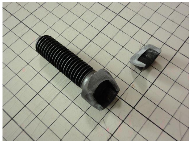
頭部が壊れたM14ボルト
