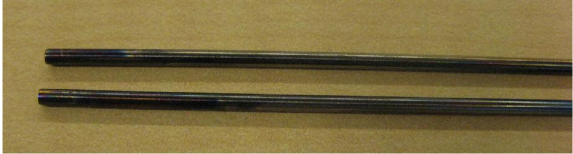
図2-4 高密度プラズマ窒化したSUS316線材。
