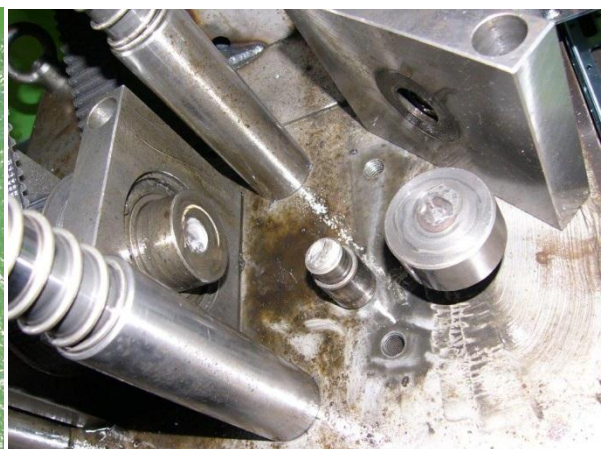
破断した振動試験機のシャフト
