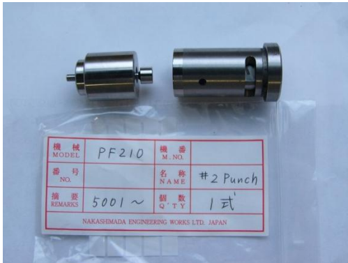
完成したN1.4ボルトブランク圧造用金型
