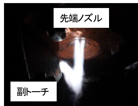
主トーチの複数プラズマと副トーチプラズマが連結した状態 （出力26kW）
