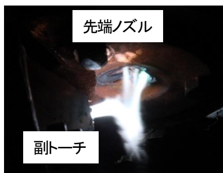
ダブルアーク発生状況(例) (出力28kW)
