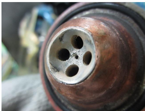
溶射後の材料噴出部
