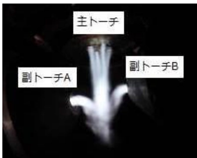
写真7 主トーチの複数プラズマ と副トーチプラズマとの連結プラズマアーク (主トーチ；4穴タイプ、 副トーチ：2個 )
