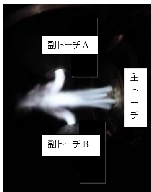
写真3 副トーチタイプ (N3 ノズルなし) (外部供給方式)
