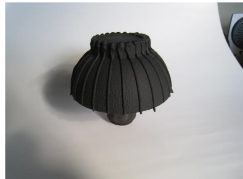
図2.4.1.2 塗料：骨材=30：70によるベースコート 図2.4.1.3 ロボットによる畝構造塗装
