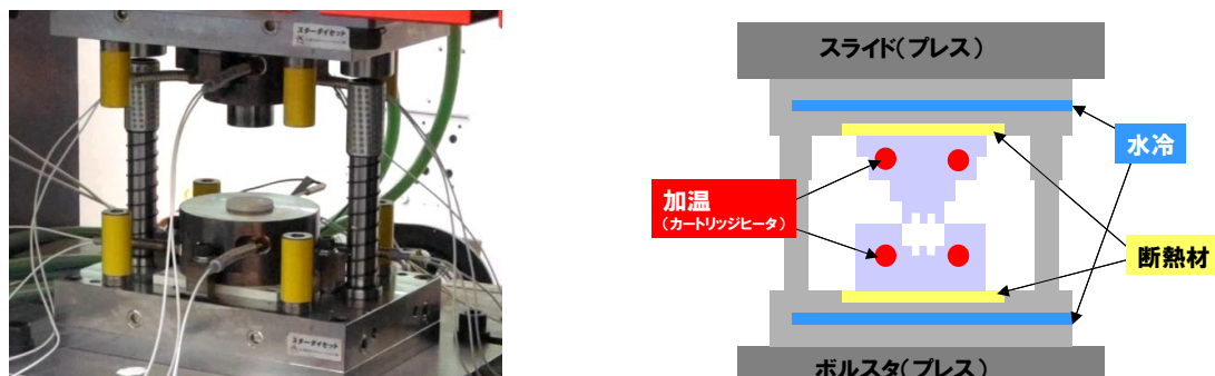
図 S2- 21 二重円筒形状金型の外観と構造
