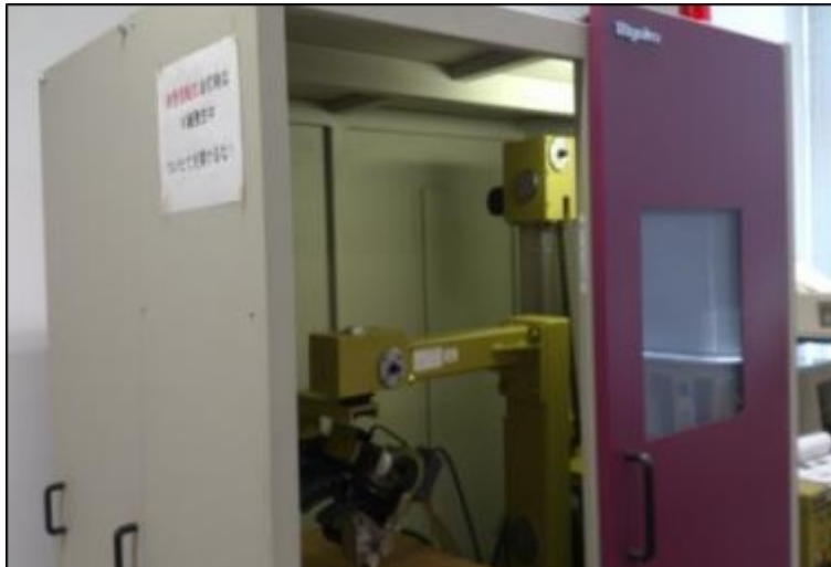
図 18 表面残留応力使用設備及び測定箇所
