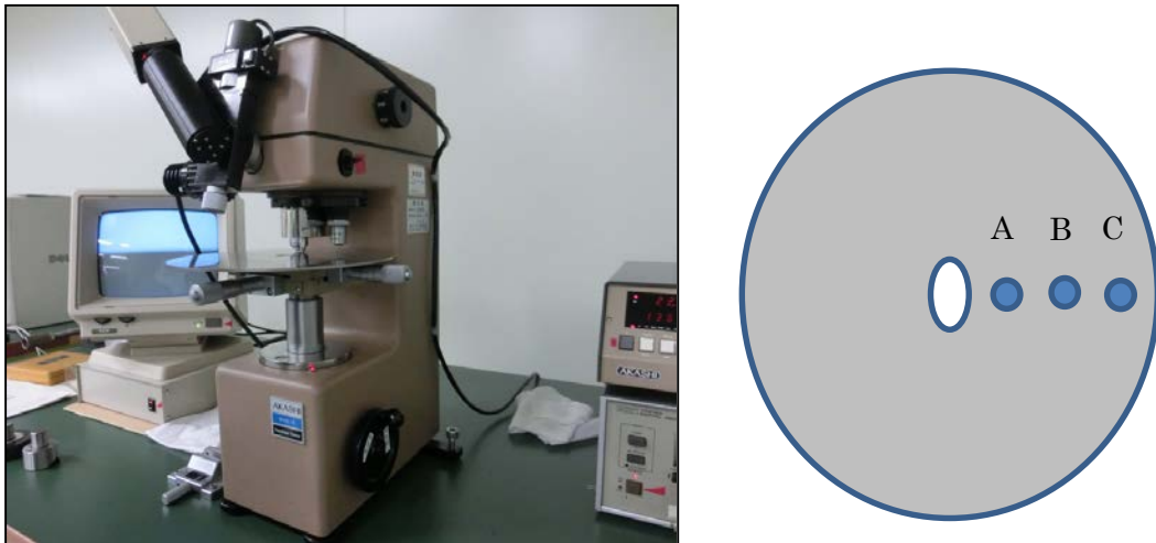
図 28 硬さ試験機及び測定箇所
