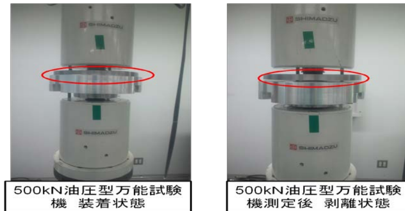
図 6 油圧型万能試験機 装着状態及び剥離状態
