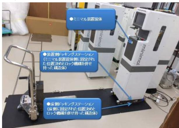
図7 装置側と床側ドッキングステーション
