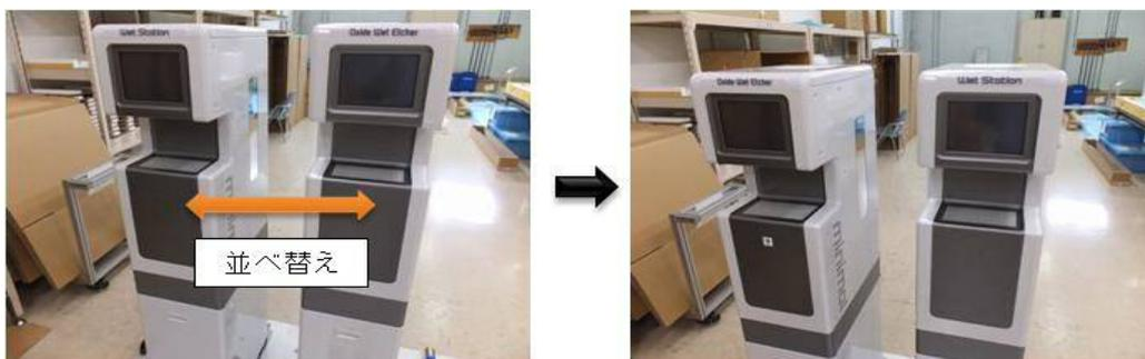
図20 ミニマル装置筐体の並べ替えテスト
