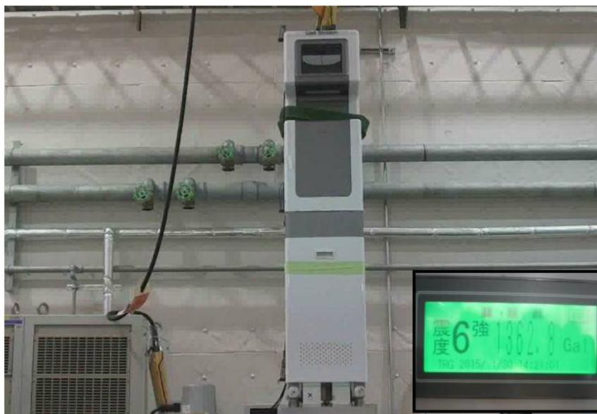
図9 耐震強度試験
