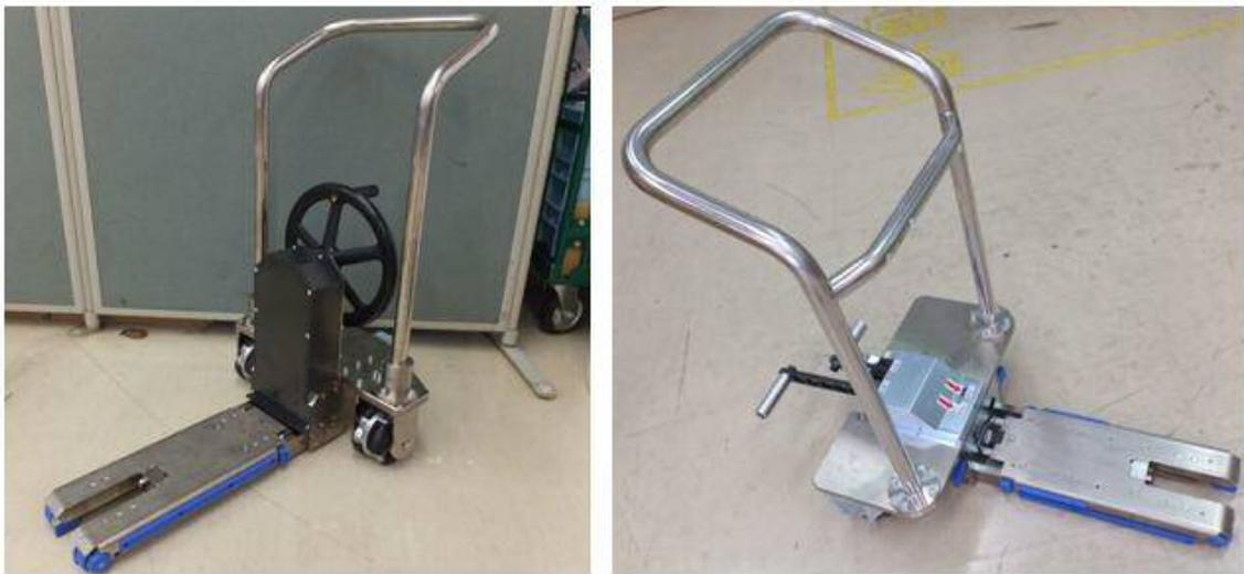
図12 ミニマルリフター（左：ボールネジ 右：油圧）
