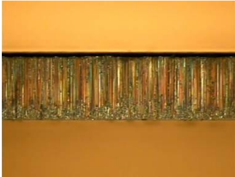
図 2-23 高精度プレス成形機を利用したせん断加工面
