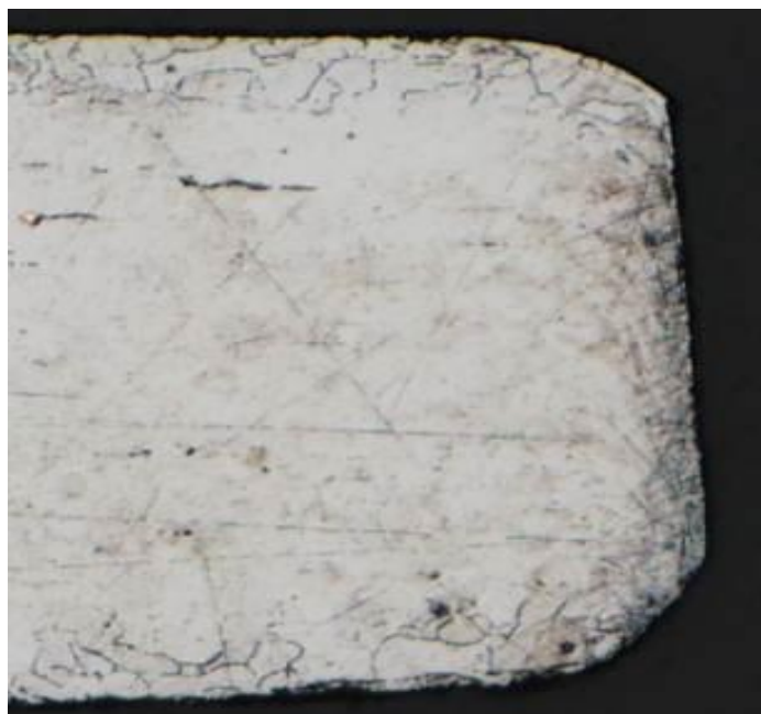
図 3-5 面打ち処理後のワーク断面
