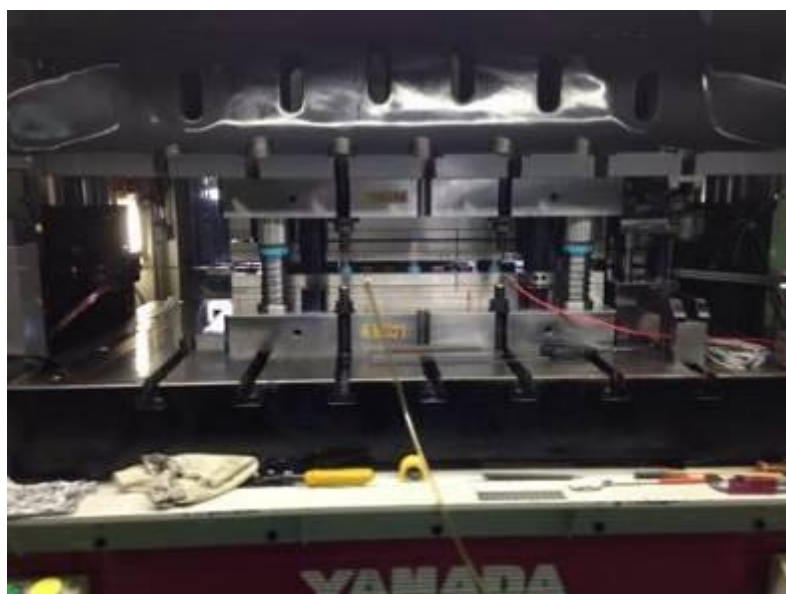
図 2-22 高精度プレス成形機によるせん断加工実験
