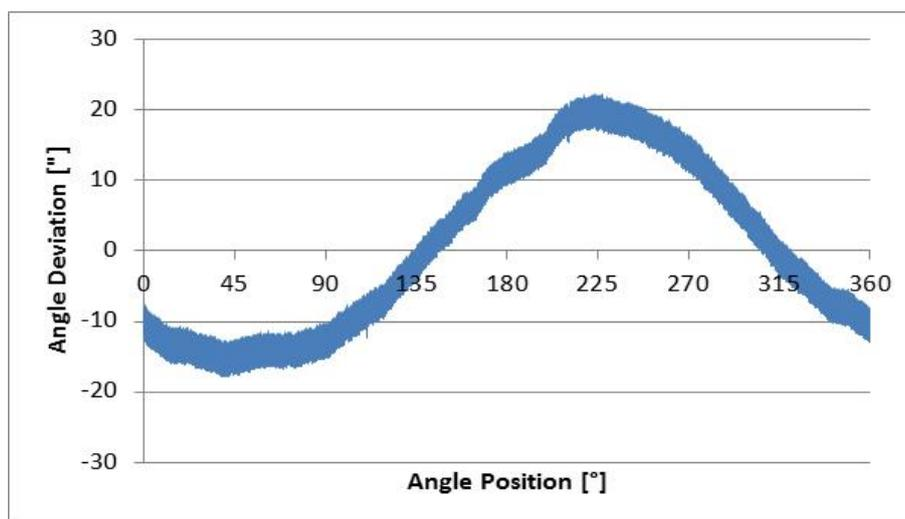
図 21 角度校正装置による角度誤差の解析結果
