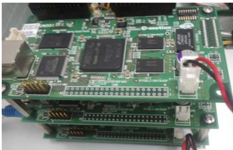
図8 時間測定型回路（下部）、パルス測定型回路（中部）、リアルタイム校正型回路のFPGAボード（上部）
