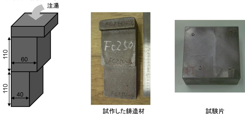
図 1-2-1 鋳鉄素材の形状及び寸法
