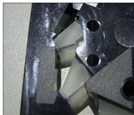
2.1.1-2 図 プリズム圧壊(旧形状)
