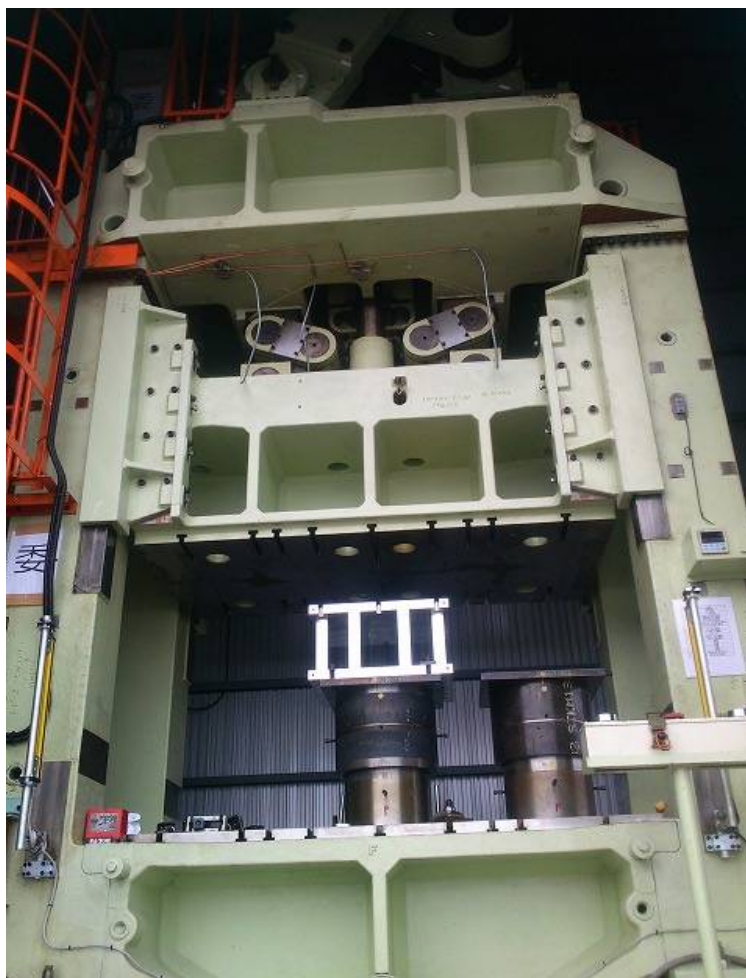
図4 開発されたカムリンクプレス（1000t）でのトライの様子
