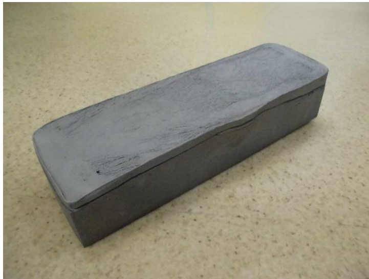
第 2.1.1-1 図 MMCインゴット (SiC45v%)
