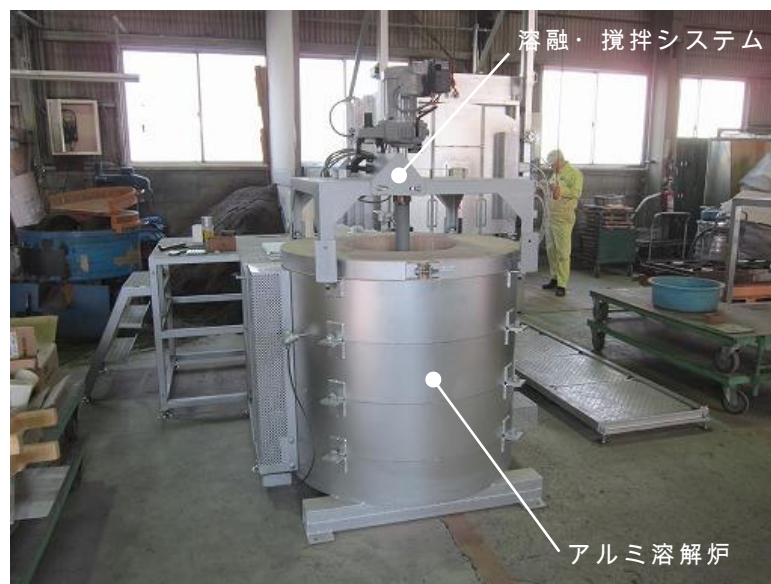
第 2.1.2-1 図 アルミ溶解炉と溶融・攪拌システム
