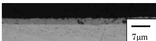
写真（２）－１－１ 外径めっき断面
