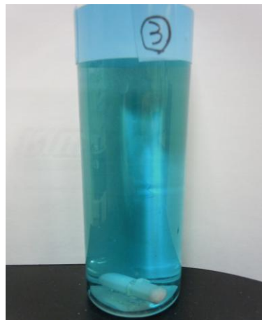
(b) 80℃での凝集剤添加ろ過後の写真
