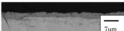
写真（２）－１－２ 内径めっき断面
