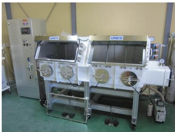
図 2.2.2 電解槽雰囲気制御装置外観
