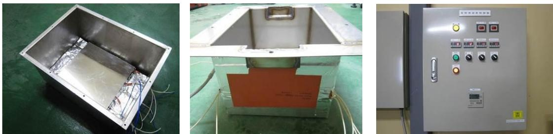
図 2.2.5-1 ホットプレート 図 2.2.5-2 シリコンラバーヒータ 図 2.2.5-3 温度調節器
