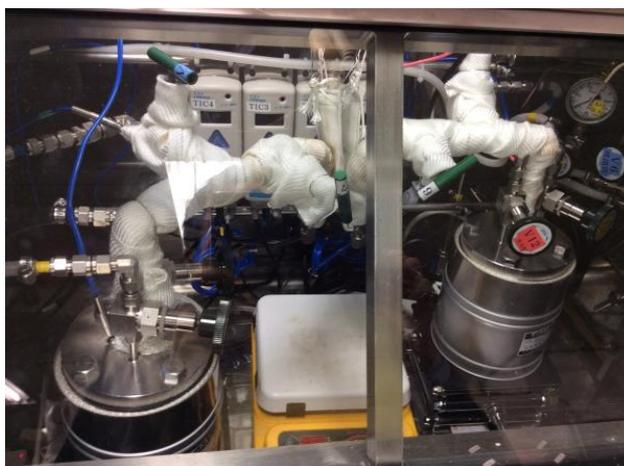
図 2.3.1-2 ナトリウム供給容器と回収容器に接続される配管の写真
