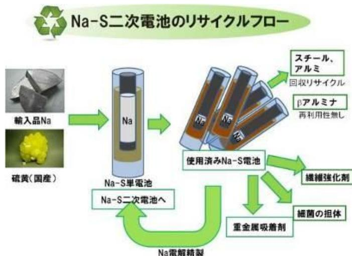
図 1 先行研究において提案したナトリウム - 硫黄二次電池のリサイクルフロー
