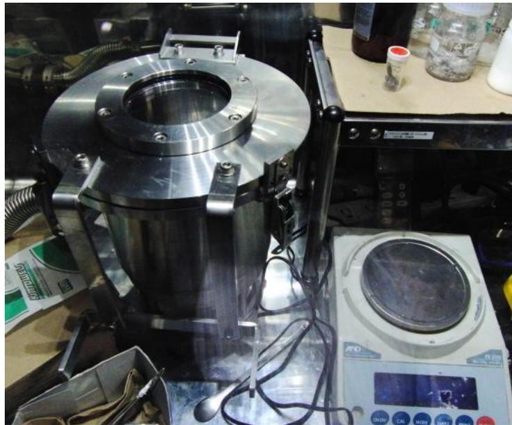
図 2.5 グローブボックス内の減圧専用チャンバーと電子天秤
