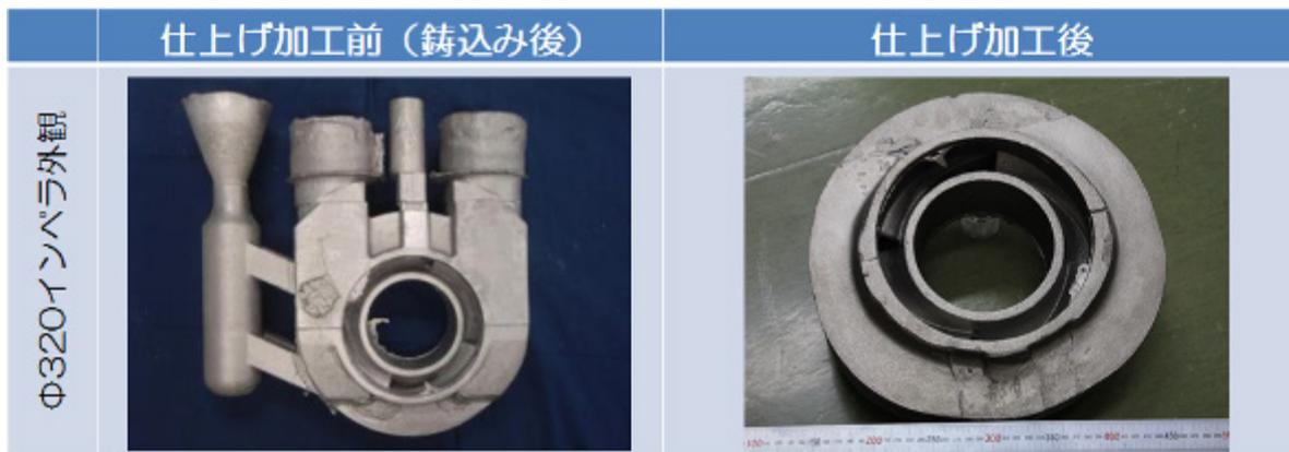
図4-2-2 方案付きインペラ鑄物と仕上げ加工後の鑄物の外観
