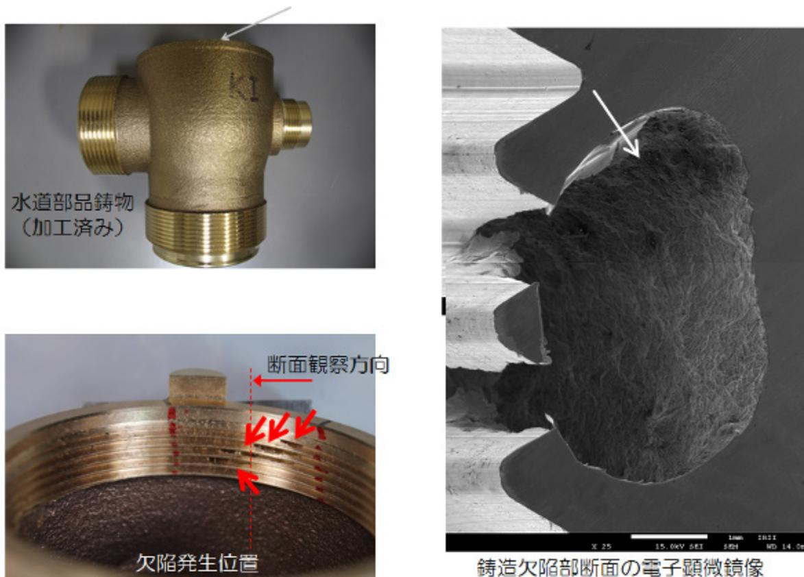
図3-2-1 欠陥部位とその部位を拡大した電子顕微鏡写真
