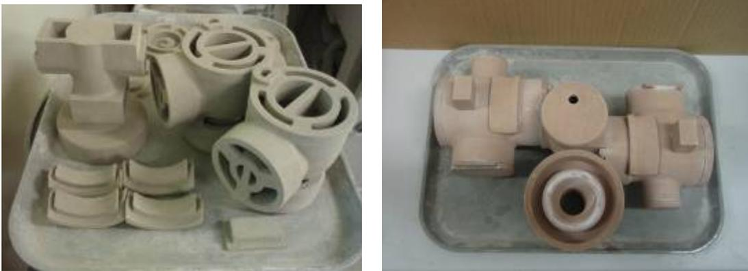
図2-2-3 分水栓の分割造形した鑄型部品（左）と組み立てが終わった RP 鑄型（右）
