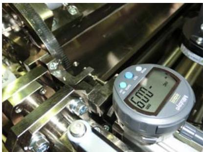
マイクロメーターによる押し込み量の微調整機構
