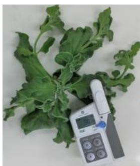
写真 2-1-2-1 葉緑素計と測定方式
