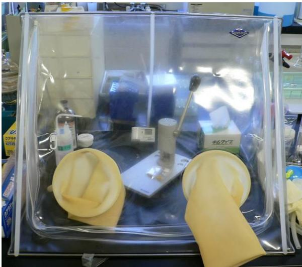
図2-7 DSC測定用アルミパンの封入作業を行った簡易グローブボックス
