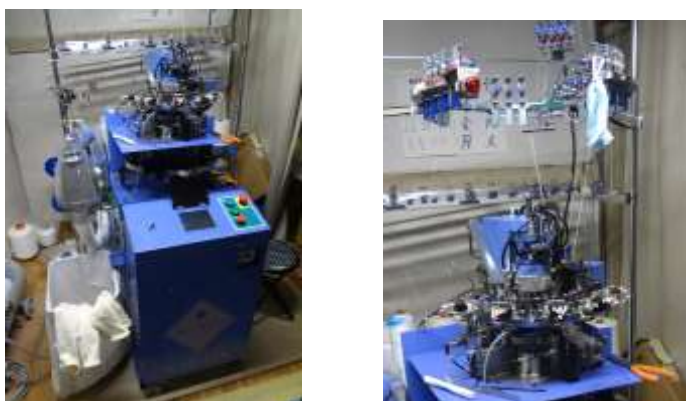
写真 2-1-3 シームレス加工ができる特殊丸編み製造機
