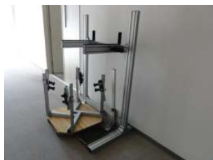
写真 1-3-1 撮影装置(上部：身体保持部 下部：カメラ設置部) 写真 1-3-2 被験者撮影時のセッティング
