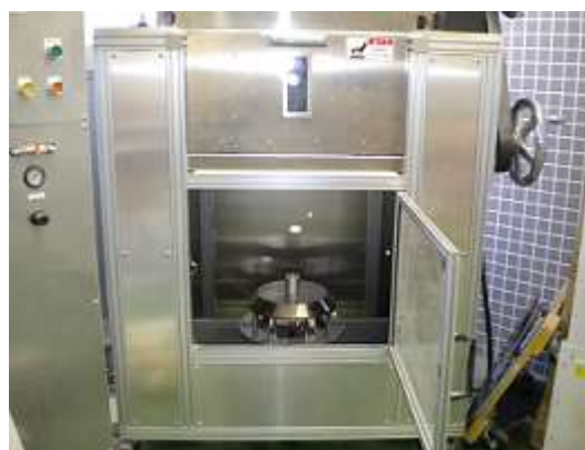
写真 2-3-2 回転機構部設置後の成形機
