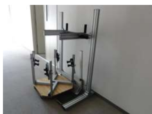
写真 3-1-1 撮影装置(上部：身体保持部 下部：カメラ設置部) 写真 3-1-2 被験者撮影時のセッティング
