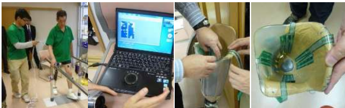
写真 2-4-2 ソケット内圧分布測定システムによる測定
