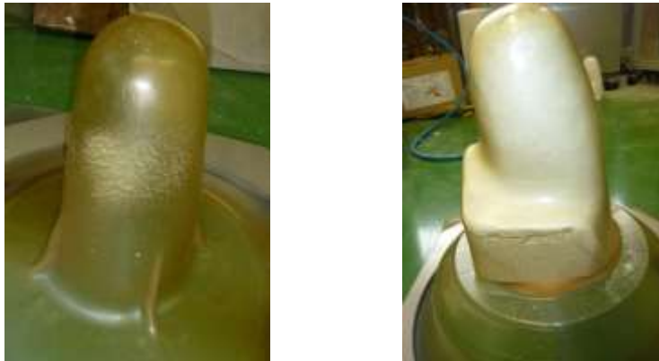
写真 2-3-3 シワ発生時のアウター原型(左)と回転機構部追加後のアウター原型(右)
