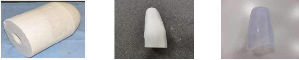
写真 3-1-4 1次モデル(左)、立体造形結果の陽性モデル(中)、樹脂加工結果(右)
