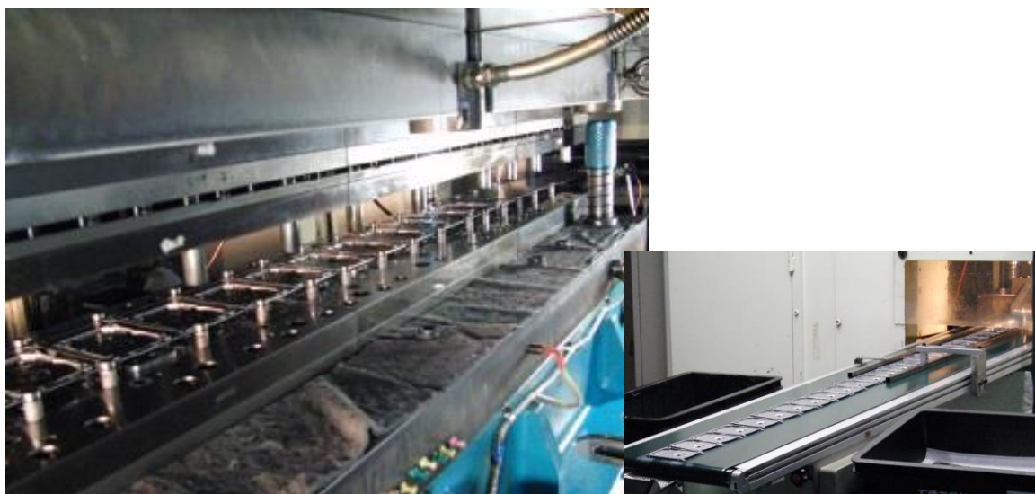
図 2.3.2 汎用プレス機械による成形トライアル（試し打ち）
