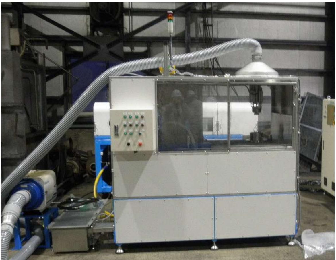
Fig.15 騒音対策を施したワークテーブル
