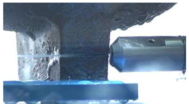
Fig. 27 高圧水吐出, 切断
