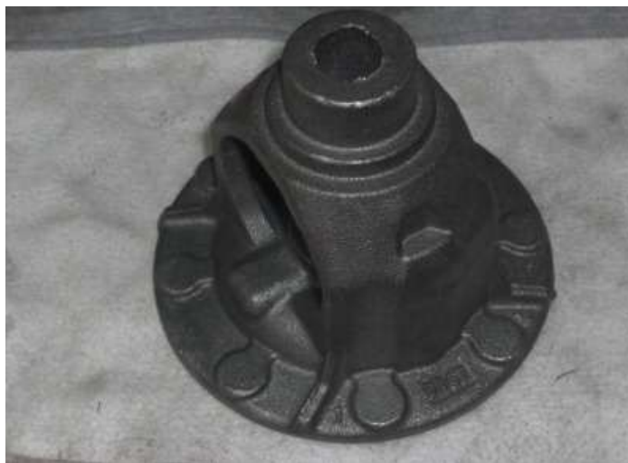
Fig. 69 切削油を使用した WJ によるバリ取り
