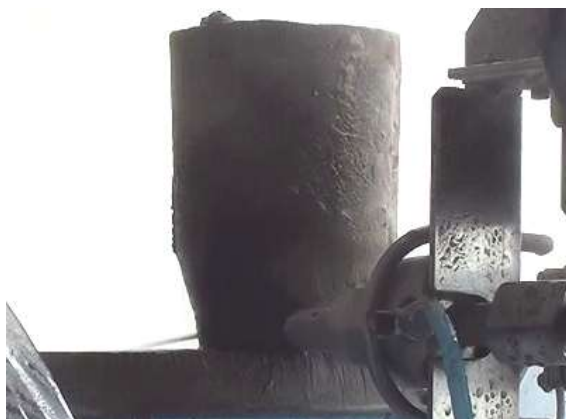
Fig. 34 高クロム鋳鉄 湯口切断
