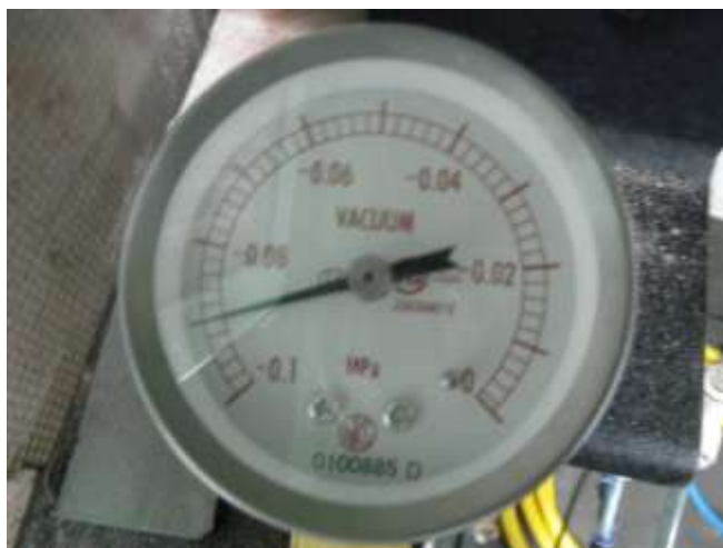
Fig.12 高圧水吐出側の最小負圧 -0.09\text{MPa}
