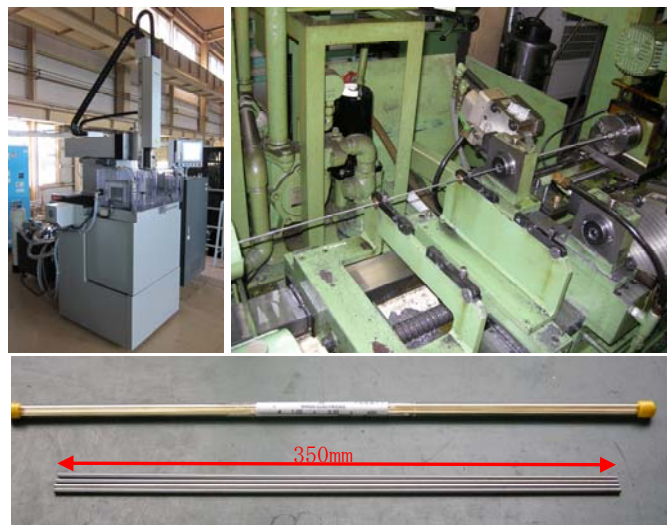
写真 1-1 (上) 細径深穴加工用機械設備 (下) 細穴放電用電極と加工部材
