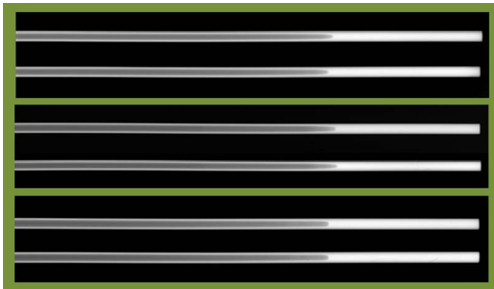
写真 2-3 X線透過撮影状態、部材 3 本を 0 度・90 度に回転して撮影
