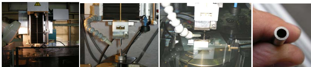
写真 2-2 φ2.5mm 細径穴加工状況と部材加工面
