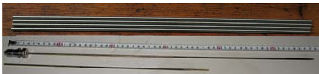
写真 2-1 (上)加工素材 SKH51 φ4.5mm (下)加工前電極と加工後の消耗電極
