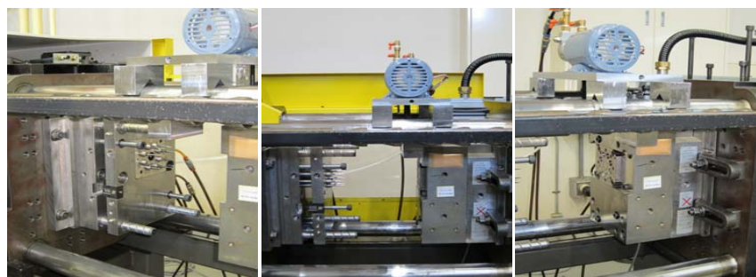
写真 2-18 検証成形のため 100 t 成形機に取付けられた 医療部品金型と専用のW形局部冷却装置
