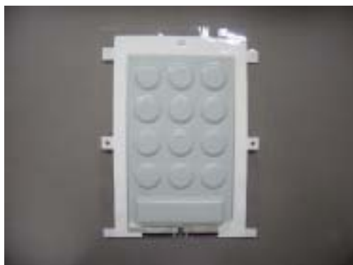
< 写真 15 : インサート成型品の低温放置試験後外観 >
