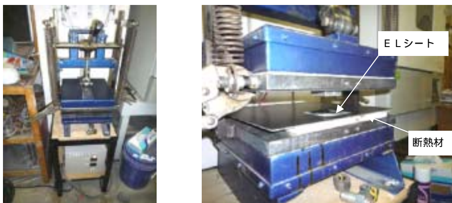
<写真1 ホットプレス全景ならびに圧縮風景>
