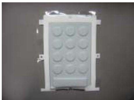
< 写真16 : インサート成型品の温度衝撃試験後外観 >
