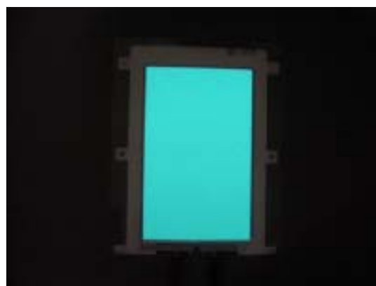
< 写真 6 : 未成形品の高温点灯試験後外観 >
