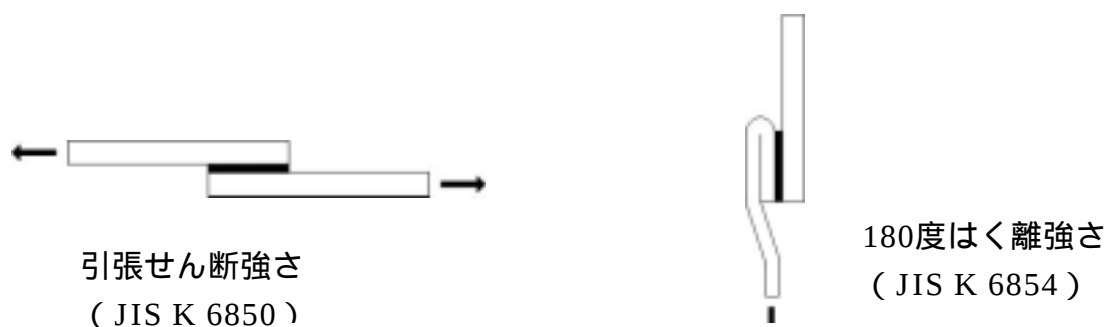
<図1 接着強さ試験法の概念図>
