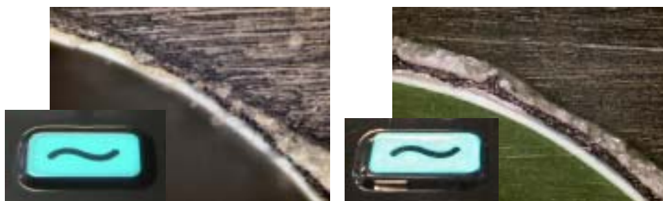
写真12 パンチR部の金属顕微鏡写真(200倍 左:PET、右:PC)
