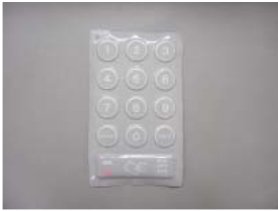
< 写真19 : 量産検証品の高温高湿点灯試験後外観 >
