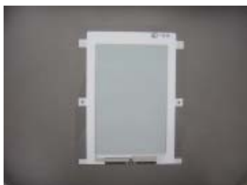
< 写真 10: 未成形品の低温点灯試験後外観 >
