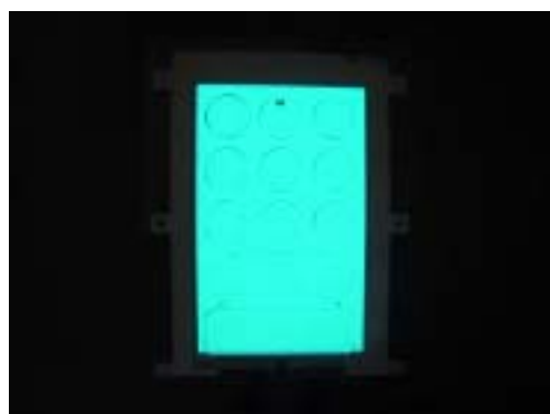
< 写真 15 : インサート成型品の低温放置試験後外観 >
