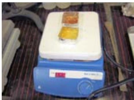
< 写真3 樹脂溶解ならびに樹脂塗布の様子 >
