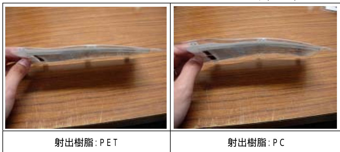
< 図10：射出樹脂の種類によるELシートのソリ >
