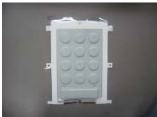
< 写真 13 : インサート成型品の高温高湿放置試験後外観 >
