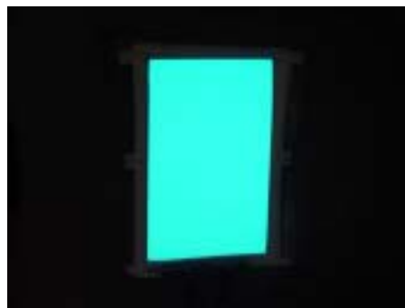
< 写真17 : 未成型品の温度衝撃試験後外観 >
