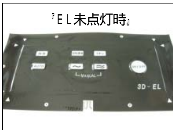
< 図18:張り出し成形結果(PC100 \mu m) >
