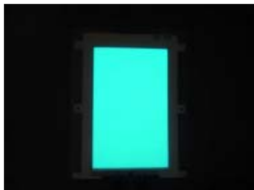
<写真12: 成型品の高温放置試験後外観>
