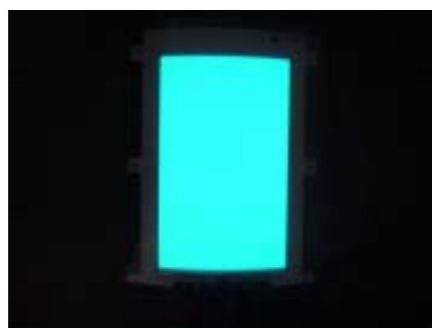
< 写真 14 : 未成型品の高温高湿放置試験後外観 >
