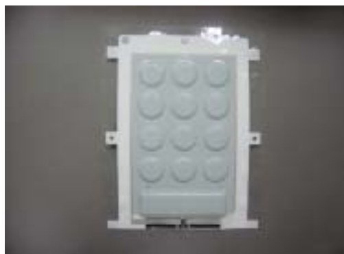
< 写真 3: インサート成形品の室温点灯試験後の外観 >
