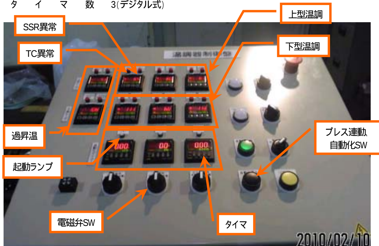
< 図3 : 温度調整、プレス連動制御装置 >
