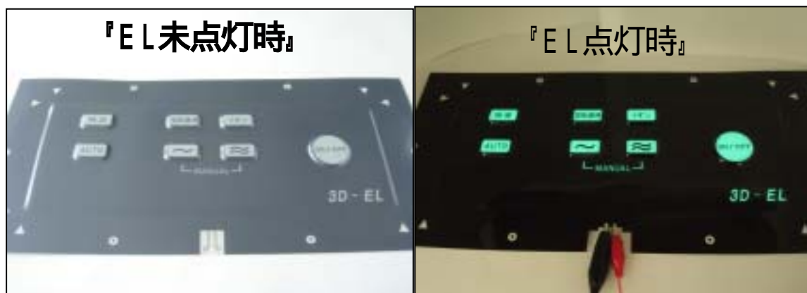
< 図15:張り出し成型結果(PC380 \mu m) >
