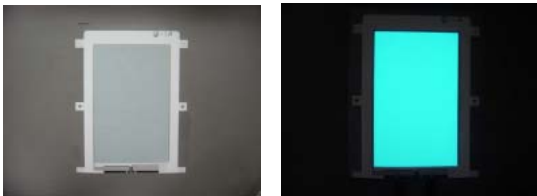
< 写真 4: 未成形品の室温点灯試験後外観 >
