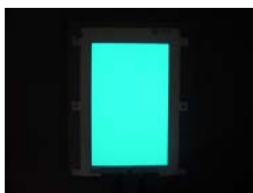
< 写真 16 : 未成型品の低温放置試験後外観 >
