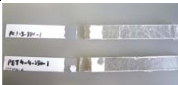
<写真9 せん断後の試験片の状態 > (上:PC下:PET)
