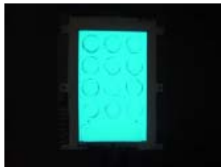
< 写真16 : インサート成型品の温度衝撃試験後外観 >
