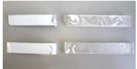
<写真11 はく離後の試験片の状態> (上:PC下:PET)
