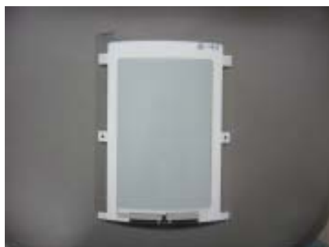
< 写真 14 : 未成型品の高温高湿放置試験後外観 >
