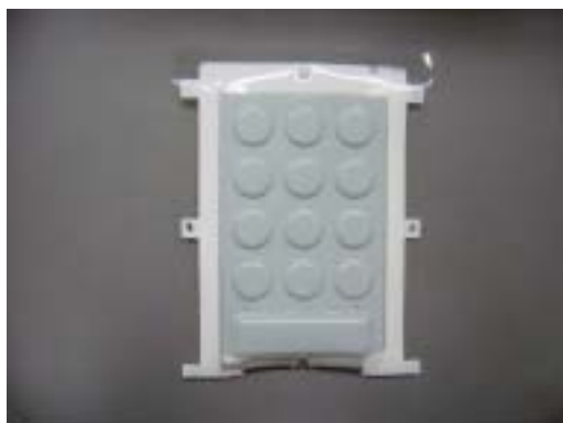
<写真11: インサート成型品の高温放置試験後外観>
