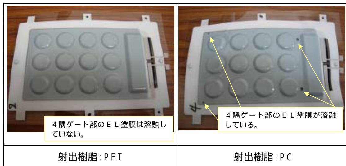
< 図12：射出樹脂の種類によるELシートのソリ >
