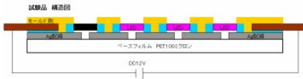
< 図5：電極端子材料選定用試験回路 >
