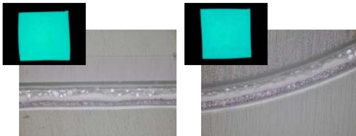
<写真5 接着層膜厚増加品の断面写真(基材 左:PET、右:PC)>
