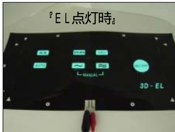
< 図18:張り出し成形結果(PC100 \mu m) >
