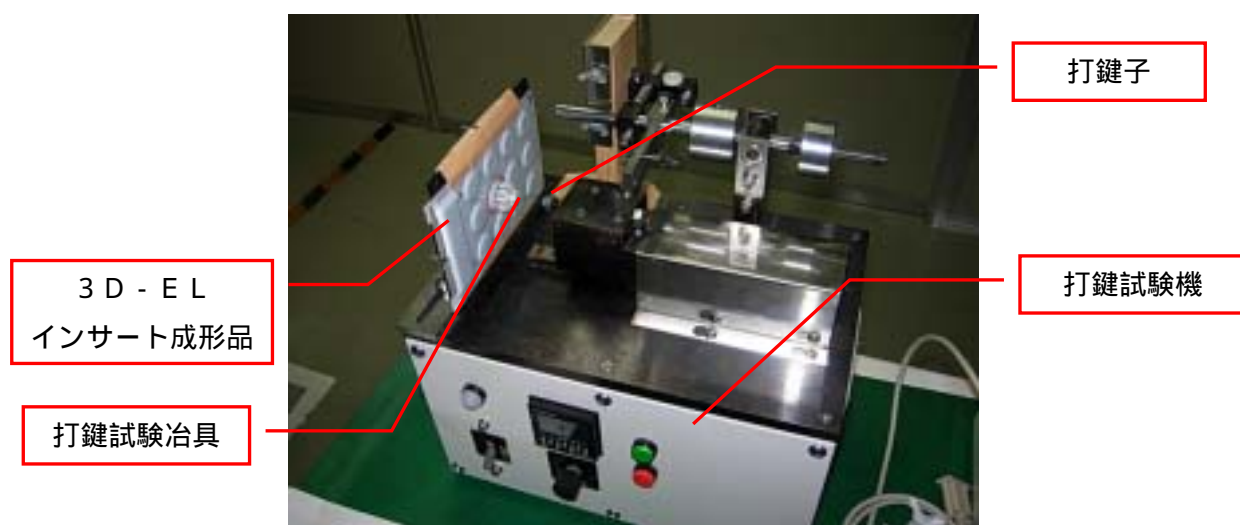
<図15:打鍵試験外観>
