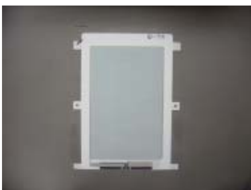
< 写真 16 : 未成型品の低温放置試験後外観 >
