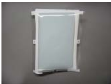
< 写真17 : 未成型品の温度衝撃試験後外観 >
