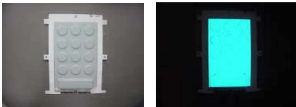
< 写真9: インサート成型品の低温点灯試験後外観 >
