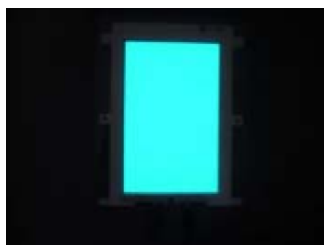
< 写真 10: 未成形品の低温点灯試験後外観 >
