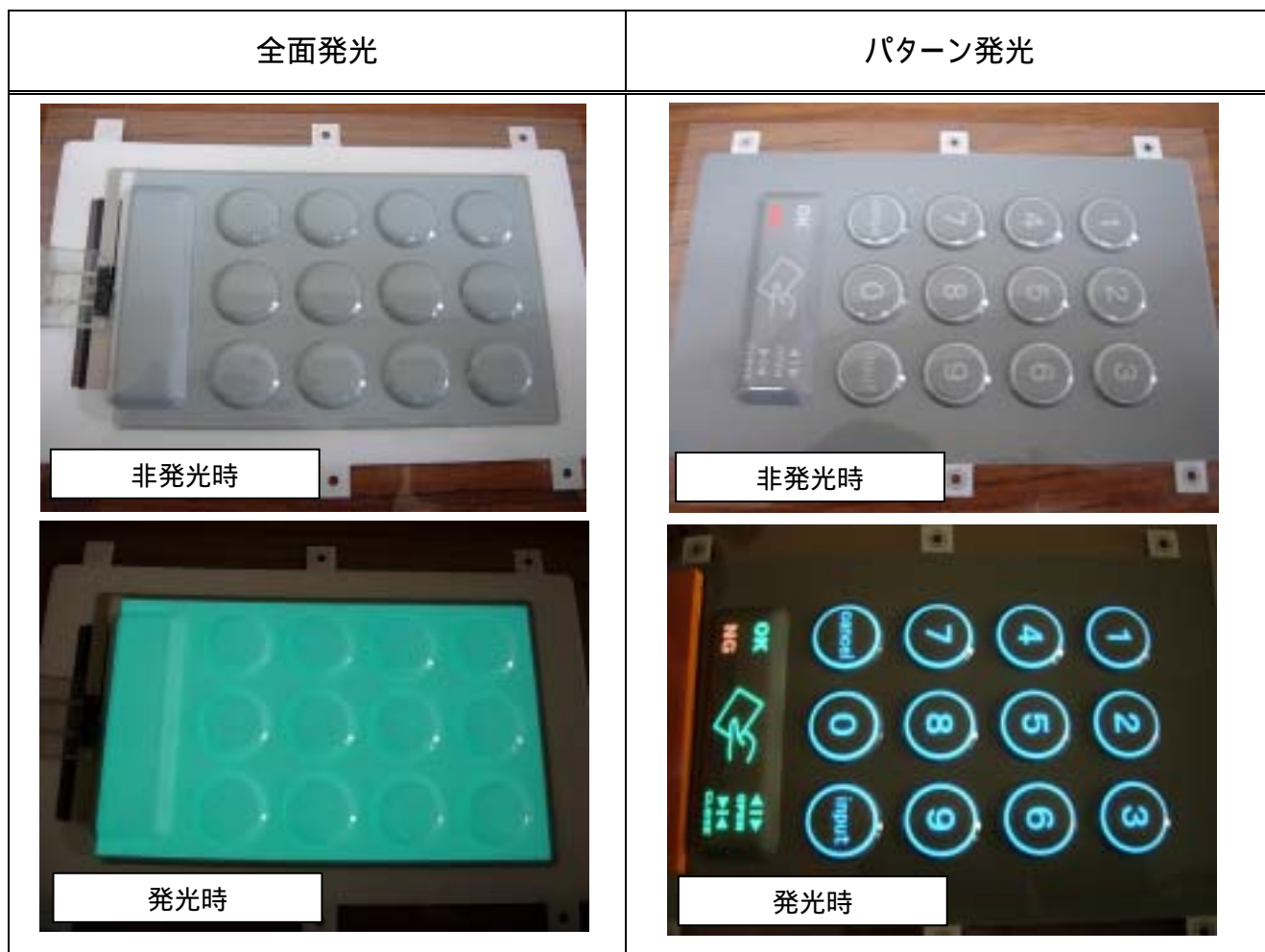
< 図8：インサート成形検証用 張出成形済み3D - EL >
