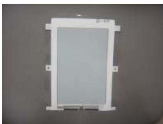
< 写真 6 : 未成形品の高温点灯試験後外観 >
