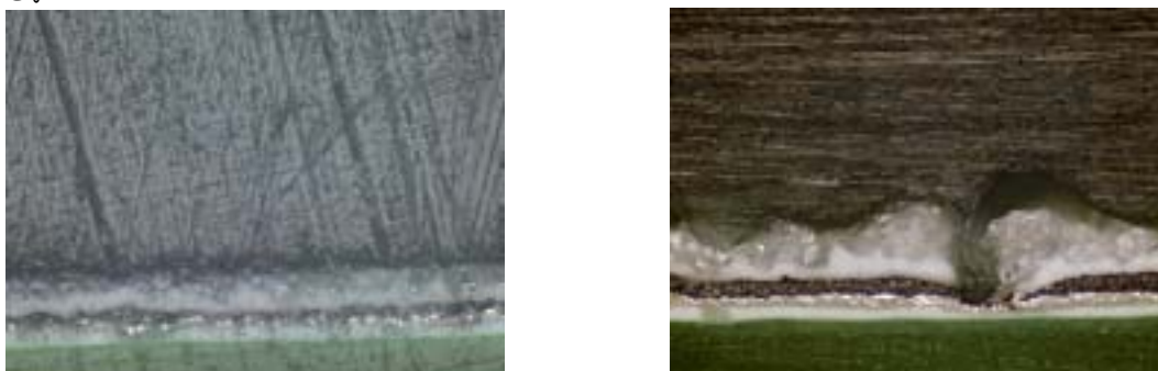
写真13 天面の金属顕微鏡写真(200倍 左:PET、右:PC)
