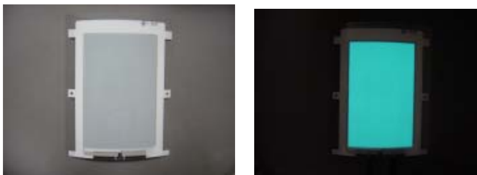
< 写真 8 : 未成形品の高温高湿点灯試験後外観 >
