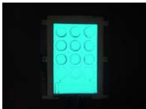
<写真11: インサート成型品の高温放置試験後外観>
