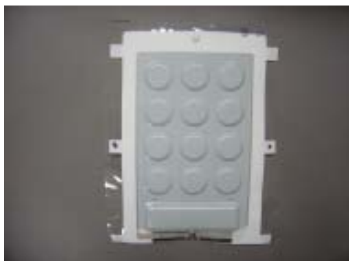
< 写真 5: インサート成型品の高温点灯試験後外観 >
