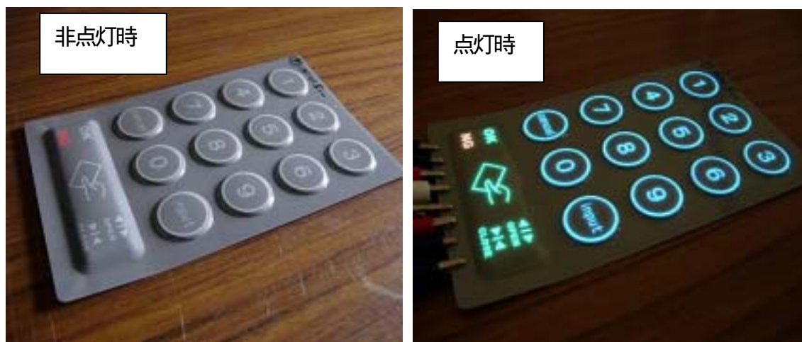
<図2 1:平成22年度 多面張出し成形型試作品の一例>
