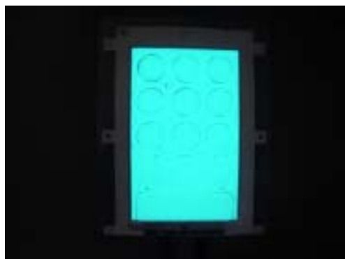
< 写真 3: インサート成形品の室温点灯試験後の外観 >
