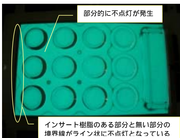
< 図11：インサート成形後のEL発光状態 >
