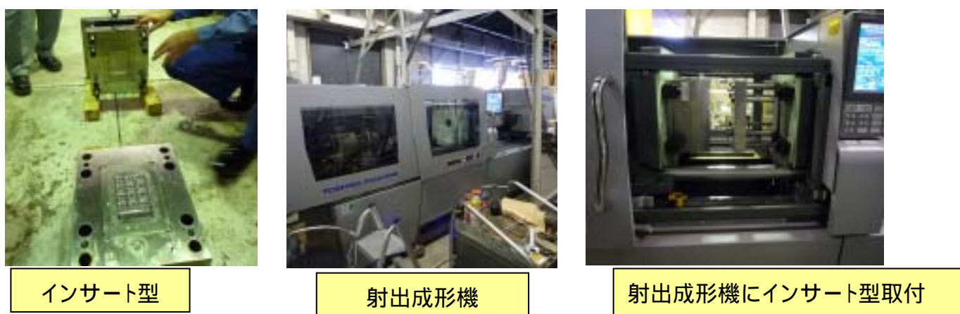
< 図9：インサート成形装置 >
