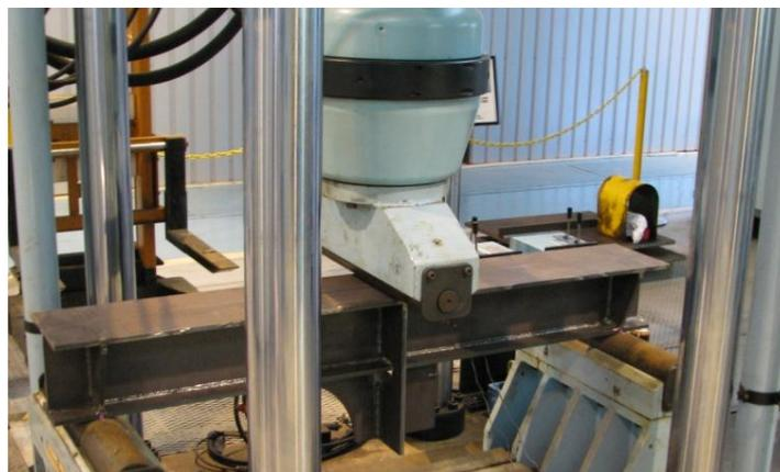
図 5-2.1 模型試験体、及び疲労試験の様子
