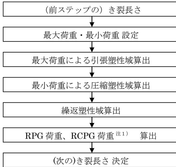
図 2-2.1 き裂成長シミュレーションの流れ
