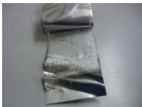
図41 環境試験前 強制剥離サンプル
