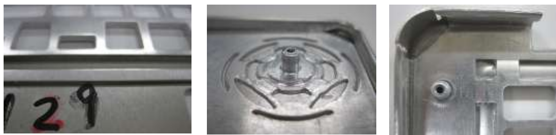
図48 接着剤漏れ量観察写真
