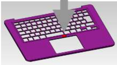
図32 圧縮強度試験イメージ
