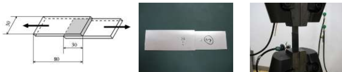
図 27 接着強度試験サンプルイメージ、実際の試験サンプルおよび接着強度試験実施状態
