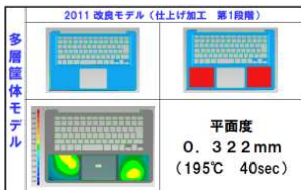
図25 平面度測定結果（1回目）
