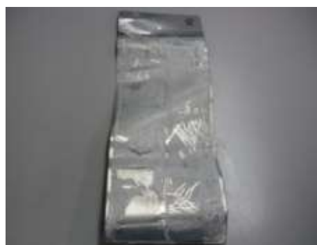
図42 環境試験後 強制剥離サンプル
