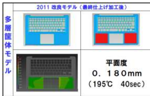
図26 平面度測定結果（最終品）
