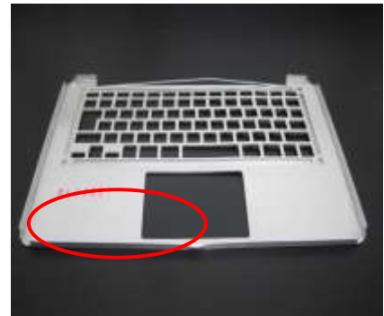
図36 未接着箇所写真（赤丸内）
