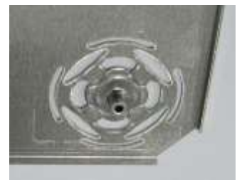
図6ボス部拡大写真 ボス高さ：5.0～5.1mm
