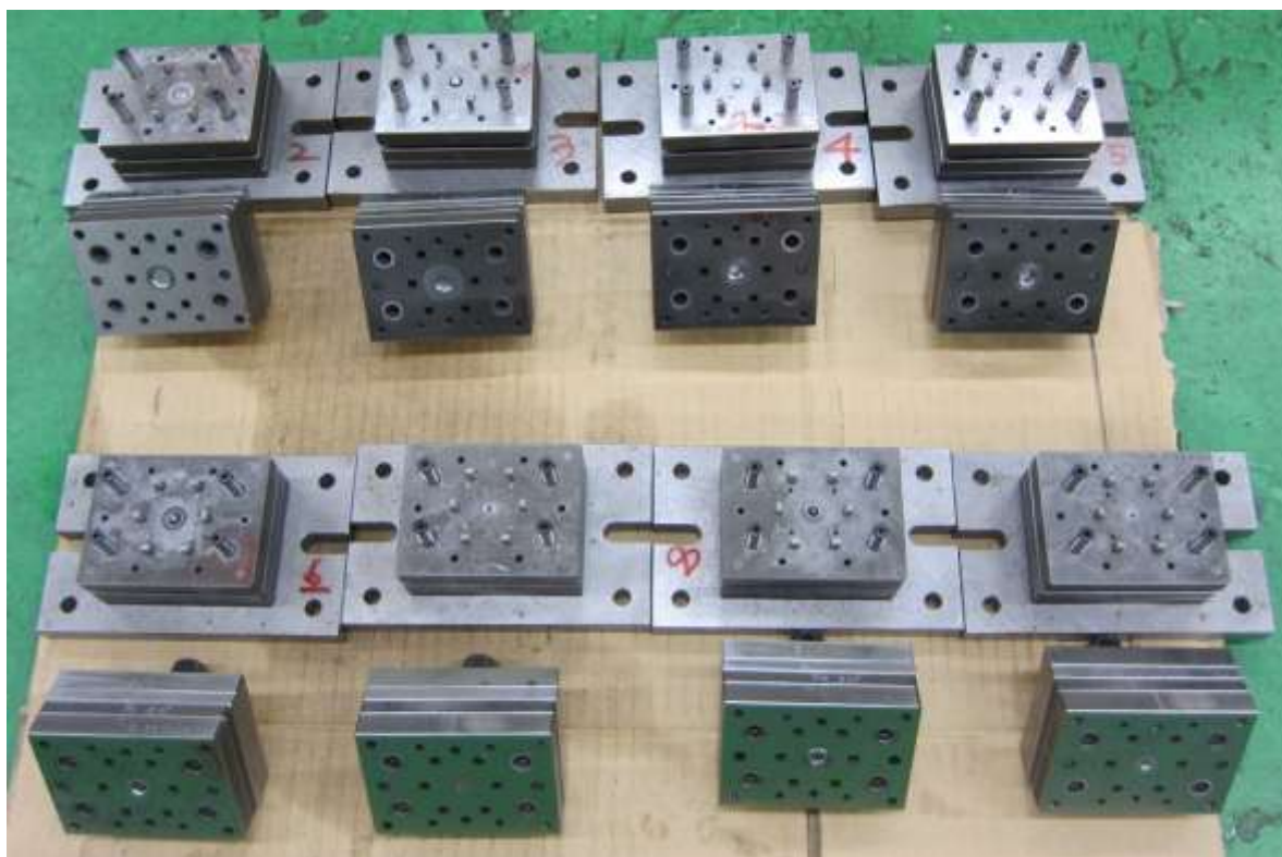
図1 ボス成形の試作型（2工程は、組み替え方式を採用 合計10工程）
