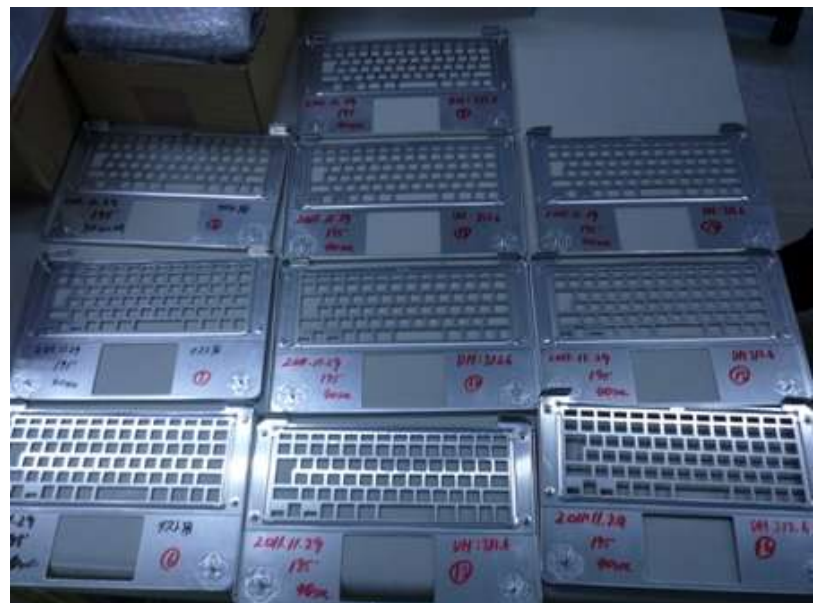
図1 4 最終製品研形状 貼り合わせ試作サンプル
