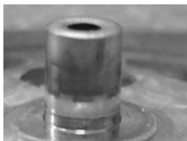
図2 ボス成形試作サンプル最終形状
