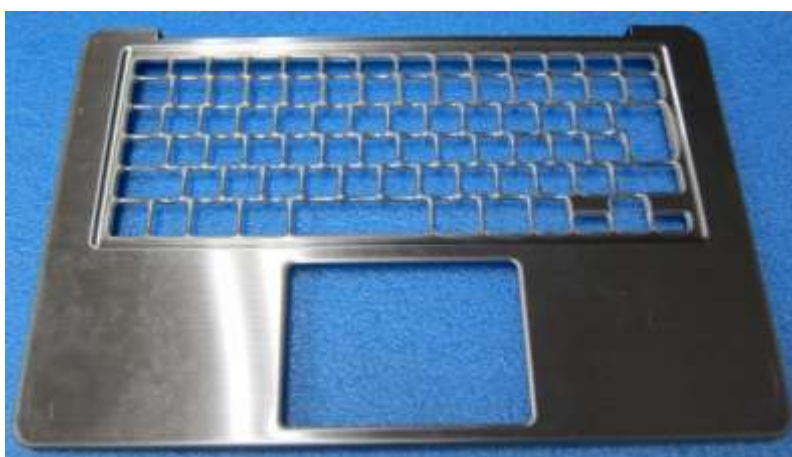
図10 SUS塗装鋼板を使用した 貼り合せ試作サンプル
