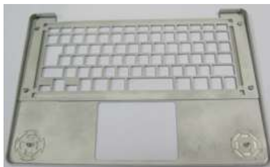
図43 85度で2時間放置した後の製品
