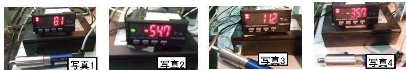
脱炭雰囲気ガスの露点降下は46.9°Cで、当初目標値30°C以上をクリアしておりOK
