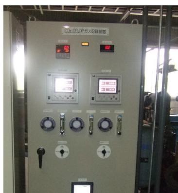
図 2-2 ガス分析・制御装置
