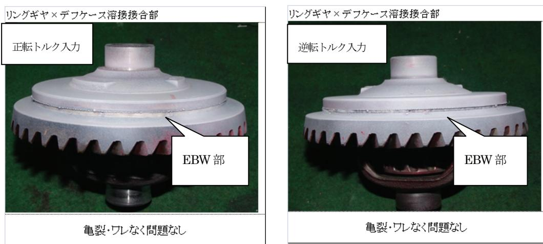
図 3-30 テスト後の試作サンプル EBW 部カラーチェック結果
