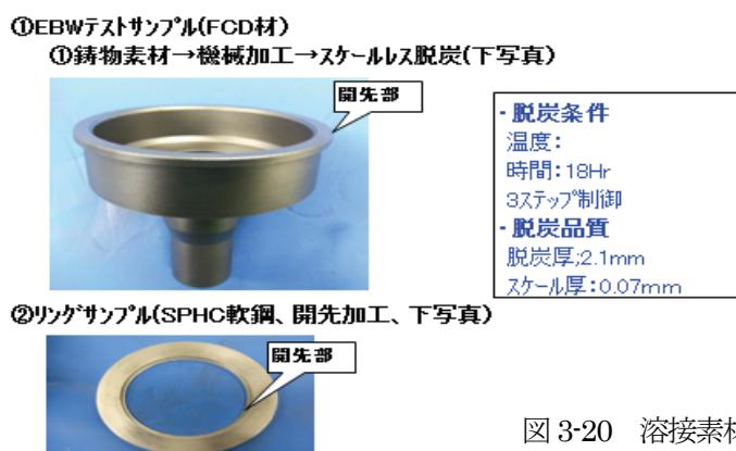
図 3-20 溶接素材条件
