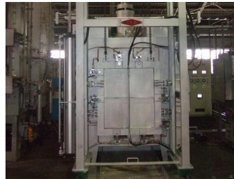
図 1-2 高密封性、高断熱性熱処理炉外観
