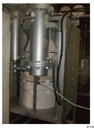
(a)燃焼筒とガス水冷装置(手前)
