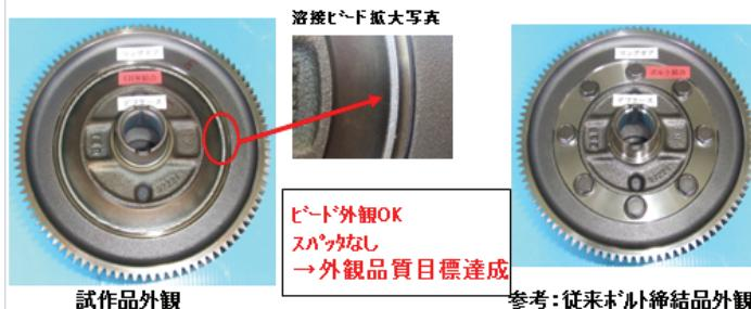
図 3-26 試作 EBW 条件、外観品質確認結果
