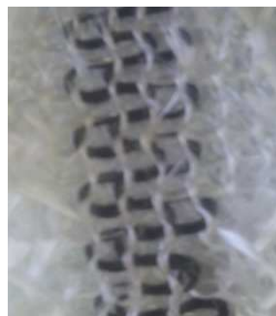
図 2-2-4 挿入された炭素繊維
