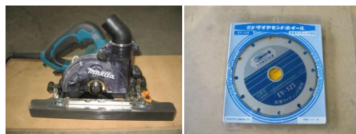
大型パネルを型上で切断するための専用装置
