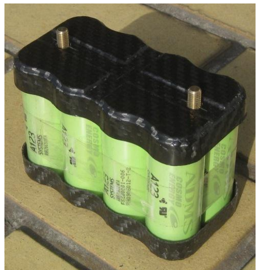
図 2-2-4 本年度製作したケースに実際にリチウム電池を格納した状態
