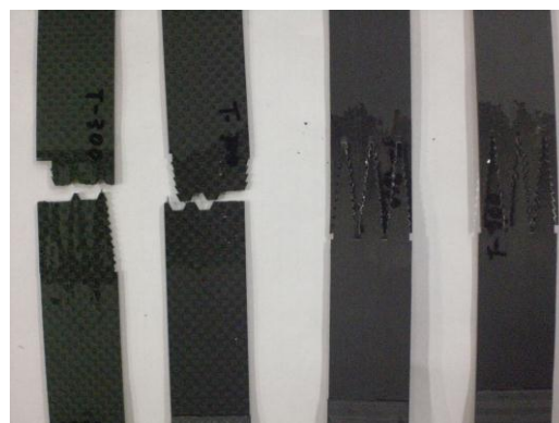
左：図 2-1-10 接着剤接合後の試料（左 3 本 T700 系、右 4 本 T300 系）
