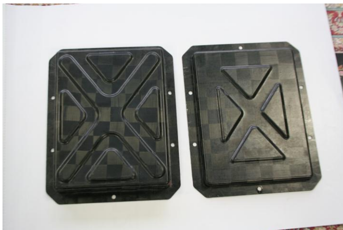
図 2-2-3 平成 22 年度製作したリチウム電池
