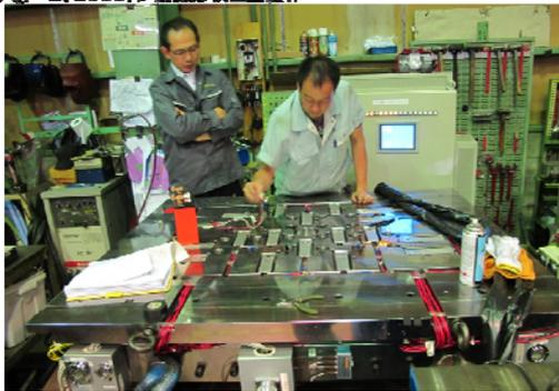
固定型金型のモーターエジェクター動作確認中の画像
