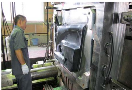
図一53 製品形状金型による成形
