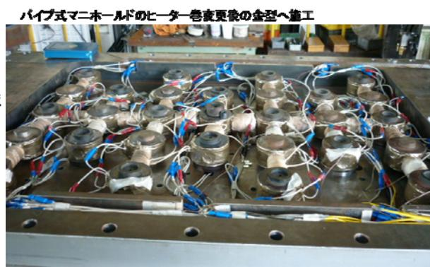
図-16 パイプ式マニホールド施工
