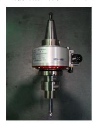
図1 超音波回転振動装置
