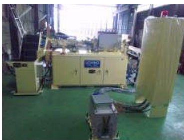
図②-2 高周波加熱装置
