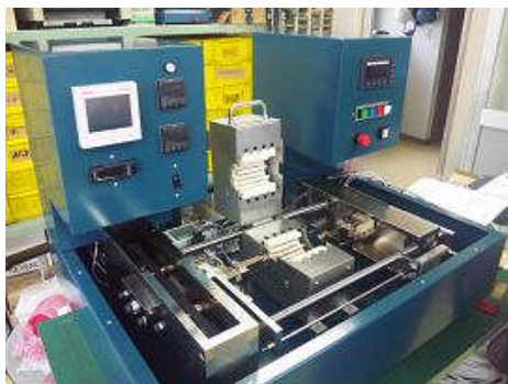
図②-4 開発した高温横型引張試験機
