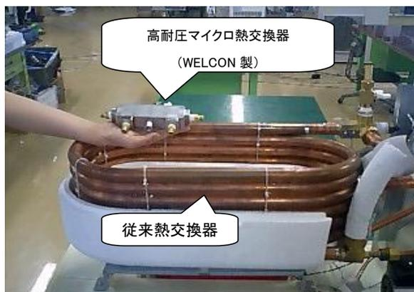
図 1.2 従来のヒートポンプ熱交換器と高耐圧マイクロ熱交換器(WELCON 製)
