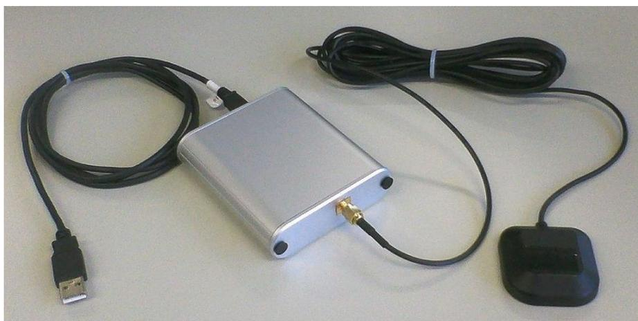
図2-5 FPGA版GPSモジュール外観写真
