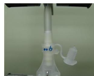
写真.コネクタ引抜き試験
