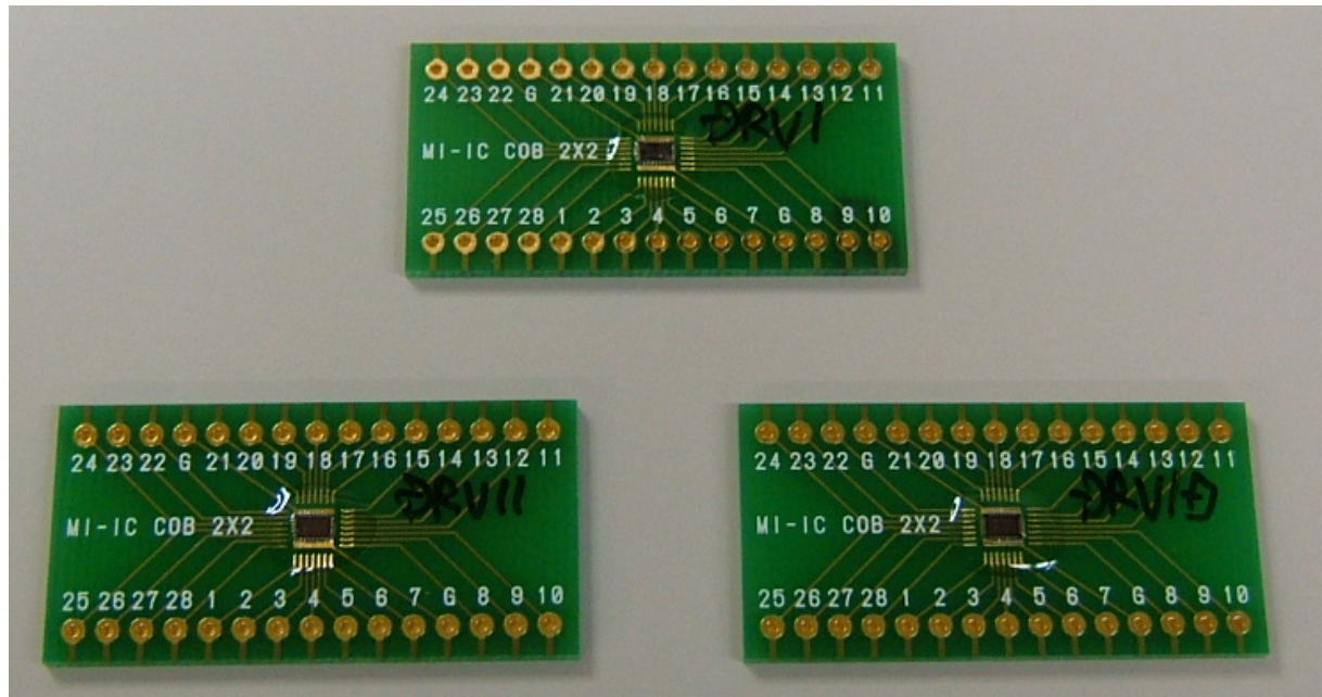
Fig. 2-20 チップ搭載済みの COB
