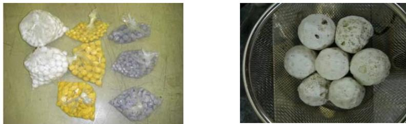
図1 セラミック脱臭剤 (セラクリン S-BALL、直径 20mm)
