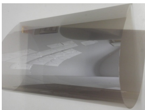
図 10 水素フリーDLC によるコーティングが施された PET フィルム
